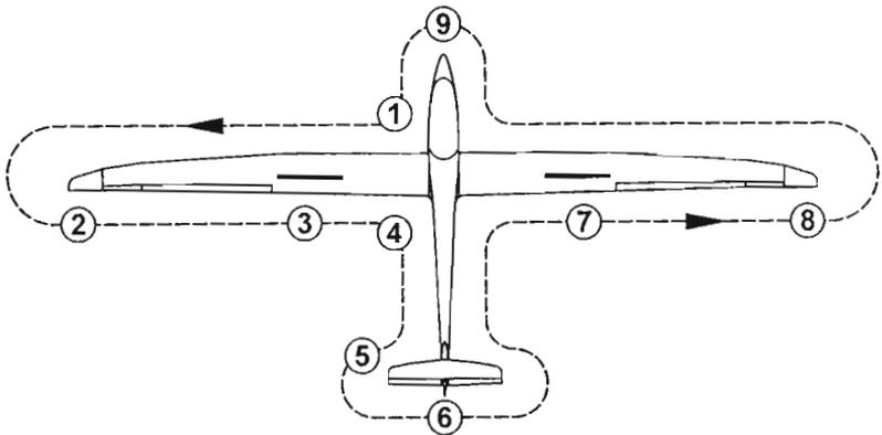
Beim Rundgang um das Flugzeug auf Lackrisse, Beulen und Unebenheiten in der Oberfläche achten; im Zweifelsfalle einen Fachmann zu Rate ziehen.
